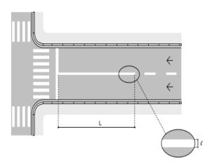
Marcas transversais (MT) - Sinalizam sobre a necessidade de reduzir a velocidade, indicam travessia de pedestres e as posições de parada.
