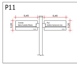
DETALHE - PLACA DE IDENTIFICAÇÃO DE LOGRADOUROS
