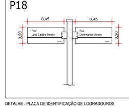
DETALHE - PLACA DE IDENTIFICAÇÃO DE LOGRADOUROS
