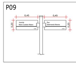
DETALHE - PLACA DE IDENTIFICAÇÃO DE LOGRADOUROS
