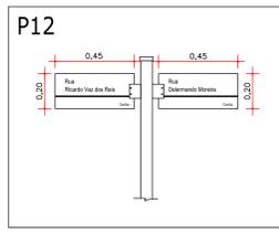
DETALHE - PLACA DE IDENTIFICAÇÃO DE LOGRADOUROS
