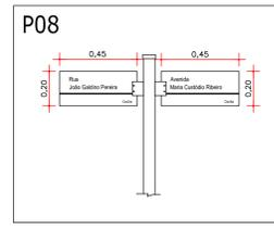
DETALHE - PLACA DE IDENTIFICAÇÃO DE LOGRADOUROS
