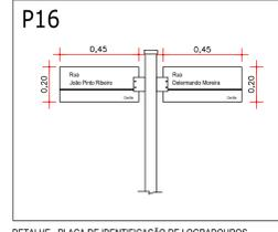
DETALHE - PLACA DE IDENTIFICAÇÃO DE LOGRADOUROS
