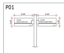
DETALHE - PLACA DE IDENTIFICAÇÃO DE LOGRADOUROS
