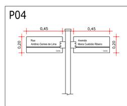
DETALHE - PLACA DE IDENTIFICAÇÃO DE LOGRADOUROS
