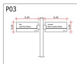
DETALHE - PLACA DE IDENTIFICAÇÃO DE LOGRADOUROS
