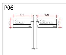
DETALHE - PLACA DE IDENTIFICAÇÃO DE LOGRADOUROS
