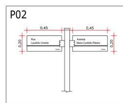
DETALHE - PLACA DE IDENTIFICAÇÃO DE LOGRADOUROS
