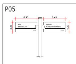
DETALHE - PLACA DE IDENTIFICAÇÃO DE LOGRADOUROS
