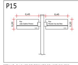
DETALHE - PLACA DE IDENTIFICAÇÃO DE LOGRADOUROS
