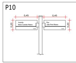
DETALHE - PLACA DE IDENTIFICAÇÃO DE LOGRADOUROS
