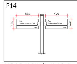
DETALHE - PLACA DE IDENTIFICAÇÃO DE LOGRADOUROS
