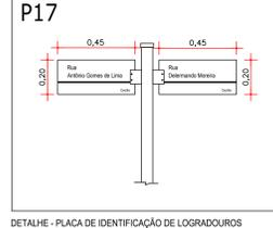
DETALHE - PLACA DE IDENTIFICAÇÃO DE LOGRADOUROS
