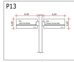
DETALHE - PLACA DE IDENTIFICAÇÃO DE LOGRADOUROS
