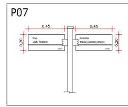
DETALHE - PLACA DE IDENTIFICAÇÃO DE LOGRADOUROS
