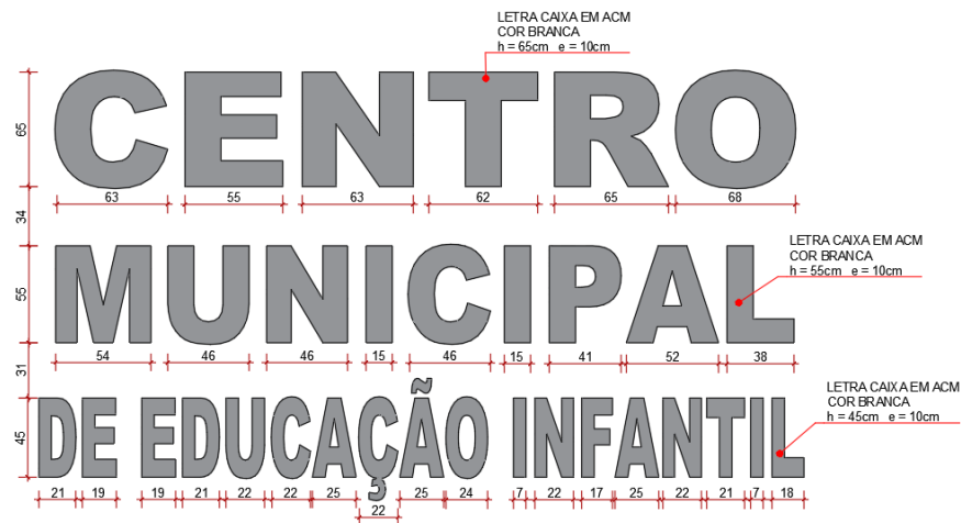
Figura 13: Detalhamento do letreiro da fachada.
