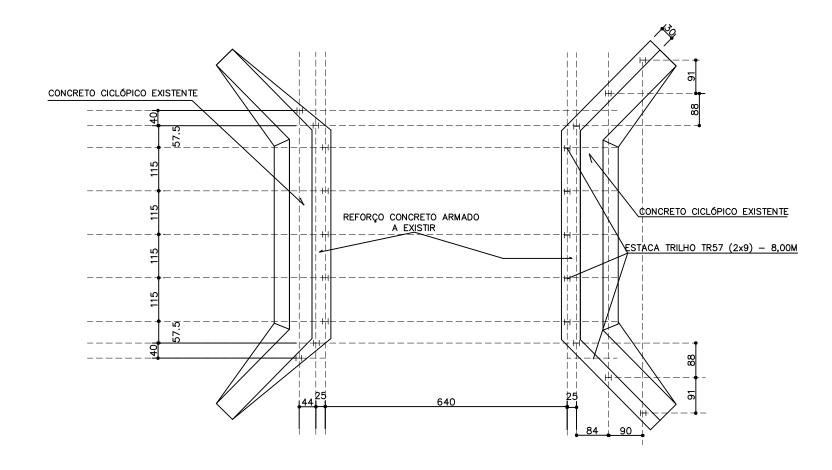
CORTE TRANSVERSAL (B) — DETALHE PEGÃO ESC.:1/100
